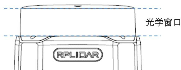
图表 2-3 RPLIDAR 光学窗口示意图
