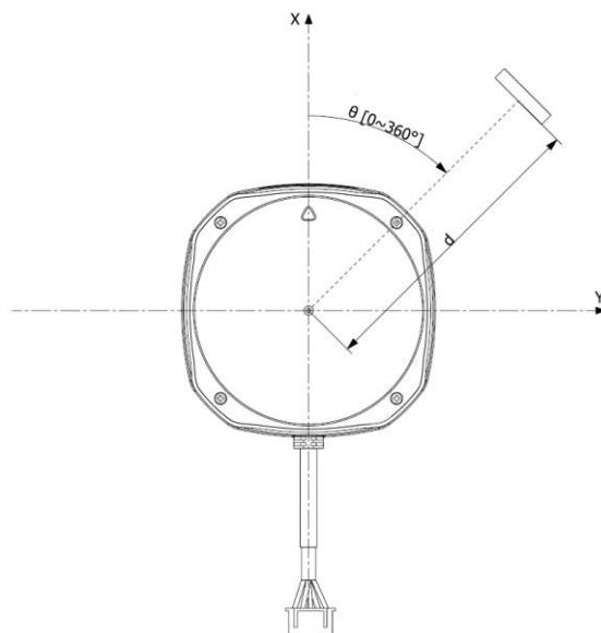
图表 2-4 RPLIDAR S2 扫描数据坐标系定义
