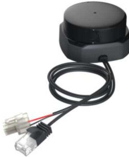
RPLIDAR S2E 是由 SLAMTEC 公司开发的新一代低成本二维激光雷达(LIDAR), 它具有每秒 32000 次的高速激光测距采样能力。并采用了非接触式的能量和信号传输技术, 克服了传统激光雷达的寿命限制, 可长时间可靠的稳定运行。
