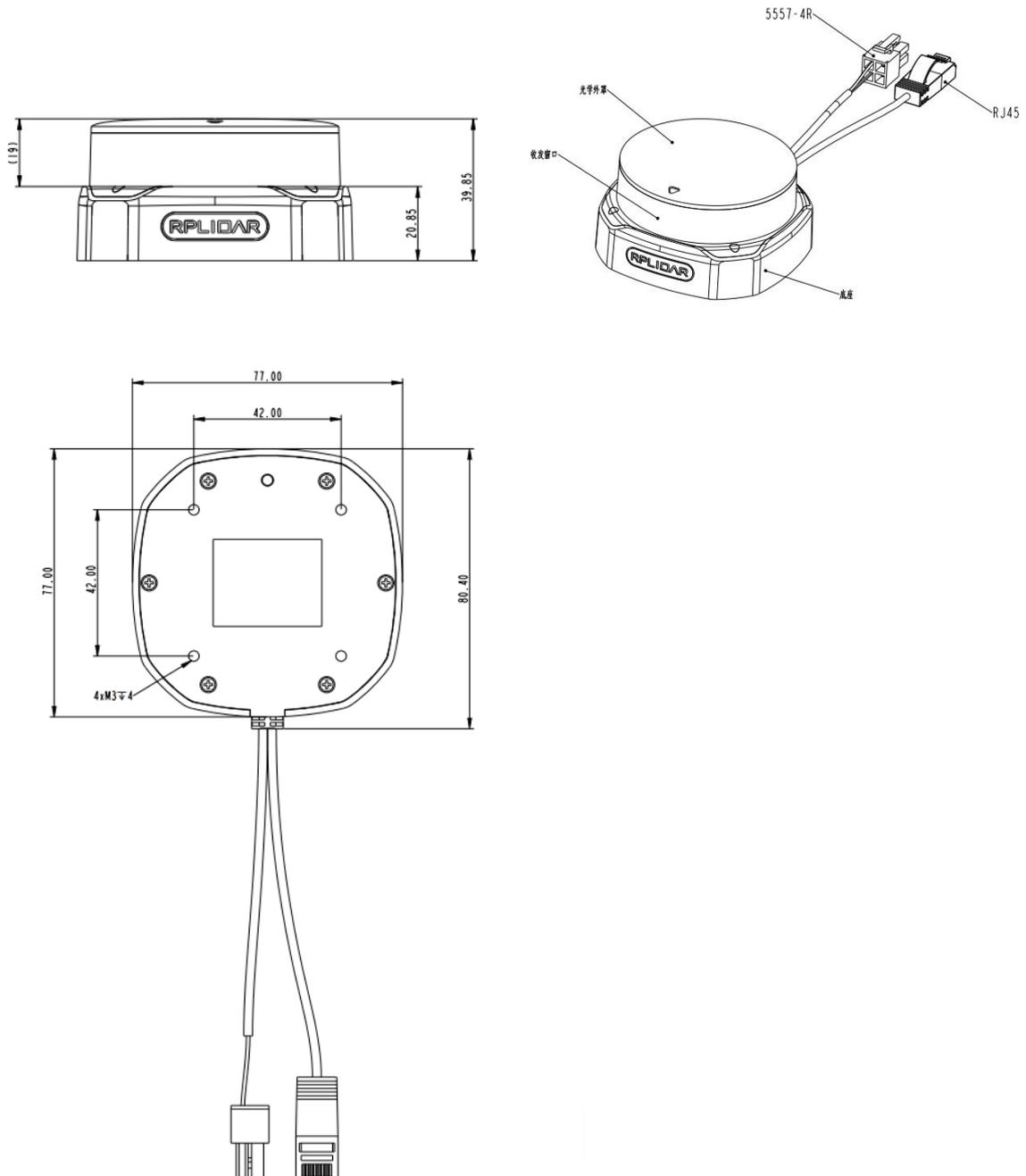
图表 4-1 RPLIDAR S2E 机械尺寸图
