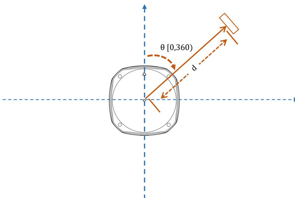
图表 2-4 RPLIDAR S2E 扫描数据坐标系定义
