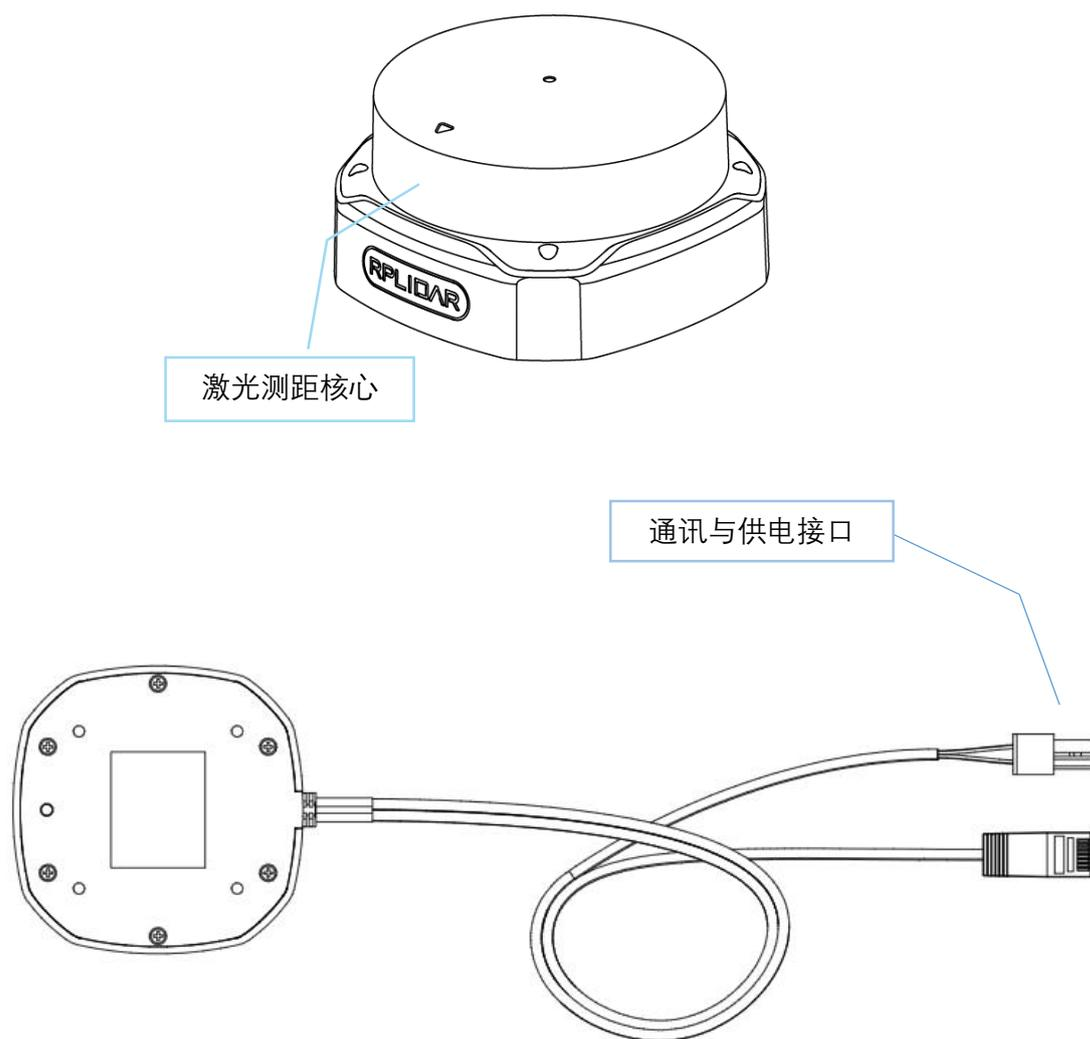
图表 1-1 RPLIDAR S2E 系统构成示意图
