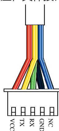
图表 2-5 RPLIDAR 电源接口定义示意图
