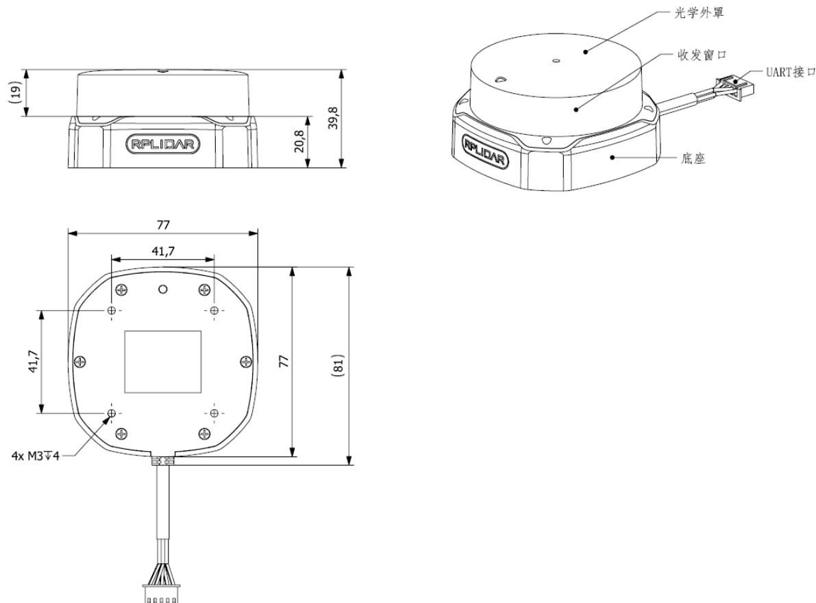
图表 4-1 RPLIDAR S2L 机械尺寸图
