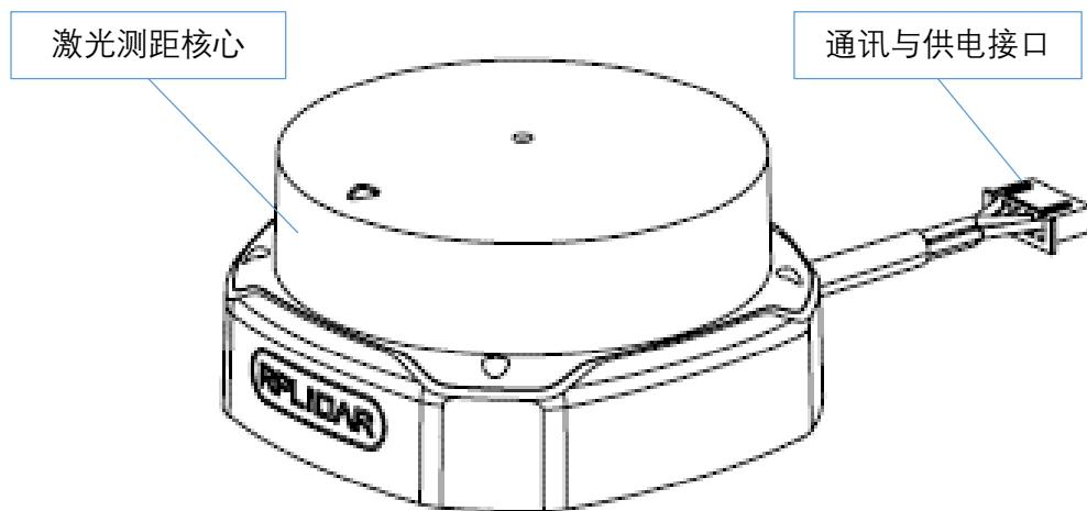
图表 1-1 RPLIDAR S2L 系统构成示意图
