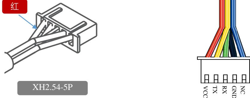
图表 2-5 RPLIDAR 电源接口定义示意图
