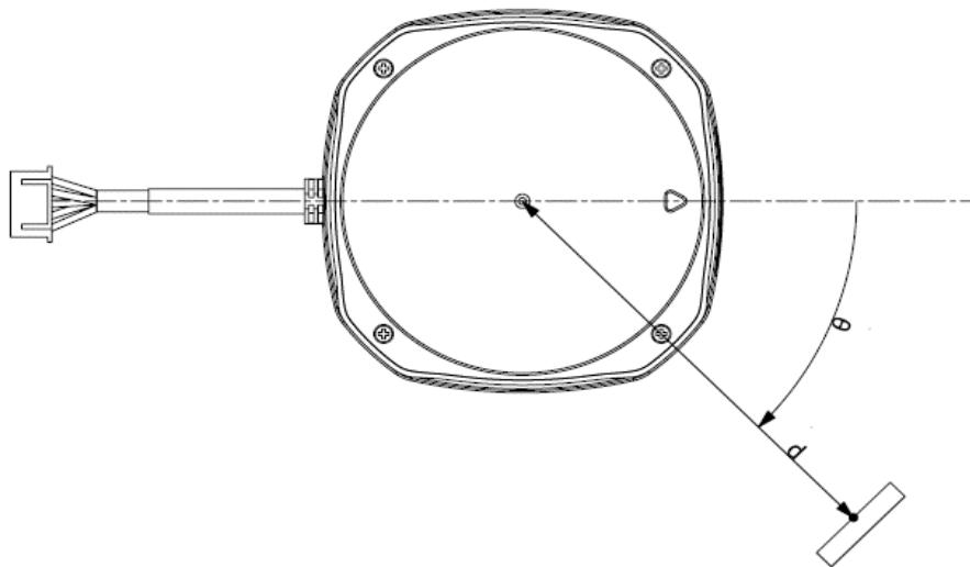
图表 1-2 RPLIDAR S2P 工作原理示意图
