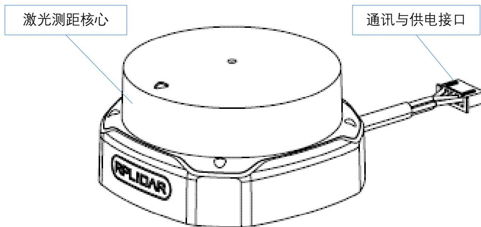
图表 1-1 RPLIDAR S2P 系统构成示意图
