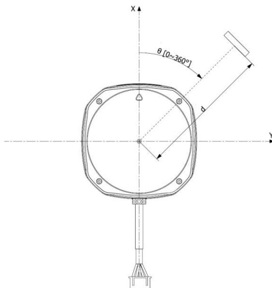
图表 2-4 RPLIDAR S2P 扫描数据坐标系定义
