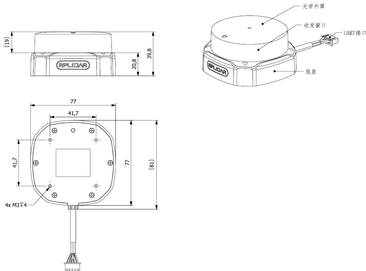
图表 4-1 RPLIDAR S2P 机械尺寸图
