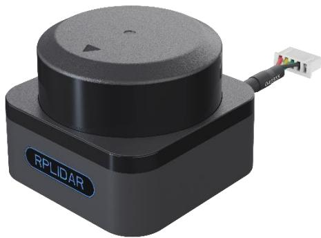
RPLIDAR S3 是由 SLAMTEC 公司开发的新一代低成本二维激光雷(LIDAR)，它具有每秒 32000 次的高速激光测距采样能力。并采用了非接触式的能量和信号传输技术，克服了传统激光雷达的寿命限制，可长时间可靠的稳定运行。
