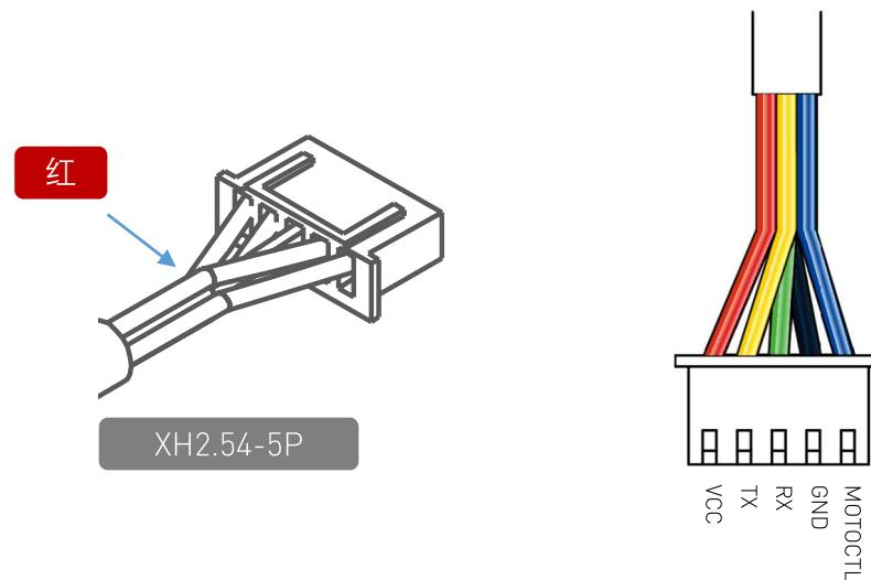
图表 3-1 RPLIDAR A3 模块引脚示意图
