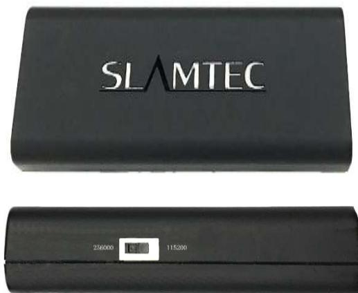
图表 1-3 RPLIDAR A3 USB 转接器实物图
