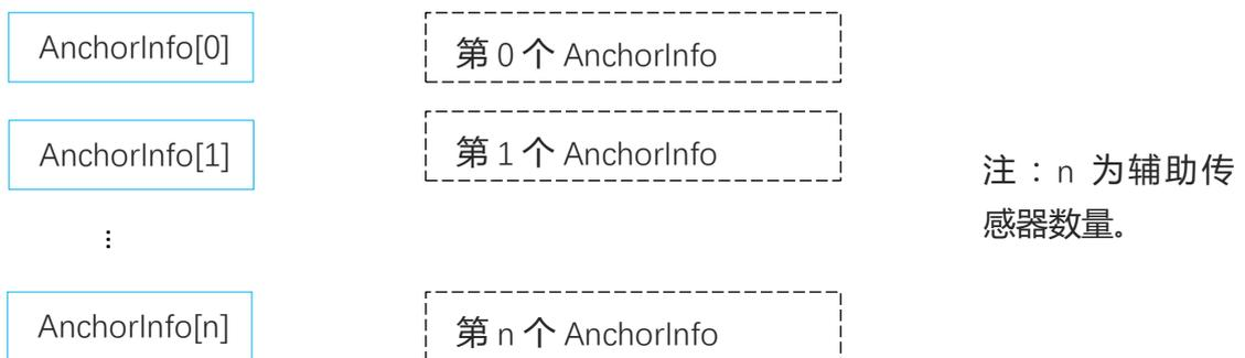
图表 4-29 GET\_AUXILIARY\_ANCHOR 命令中 AnchorInfo 的数据格式
